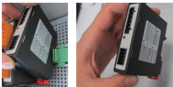
Regulatoriaus modulių išmontavimas – 2 dalis (panašu į paveikslėlio vaizdą)
